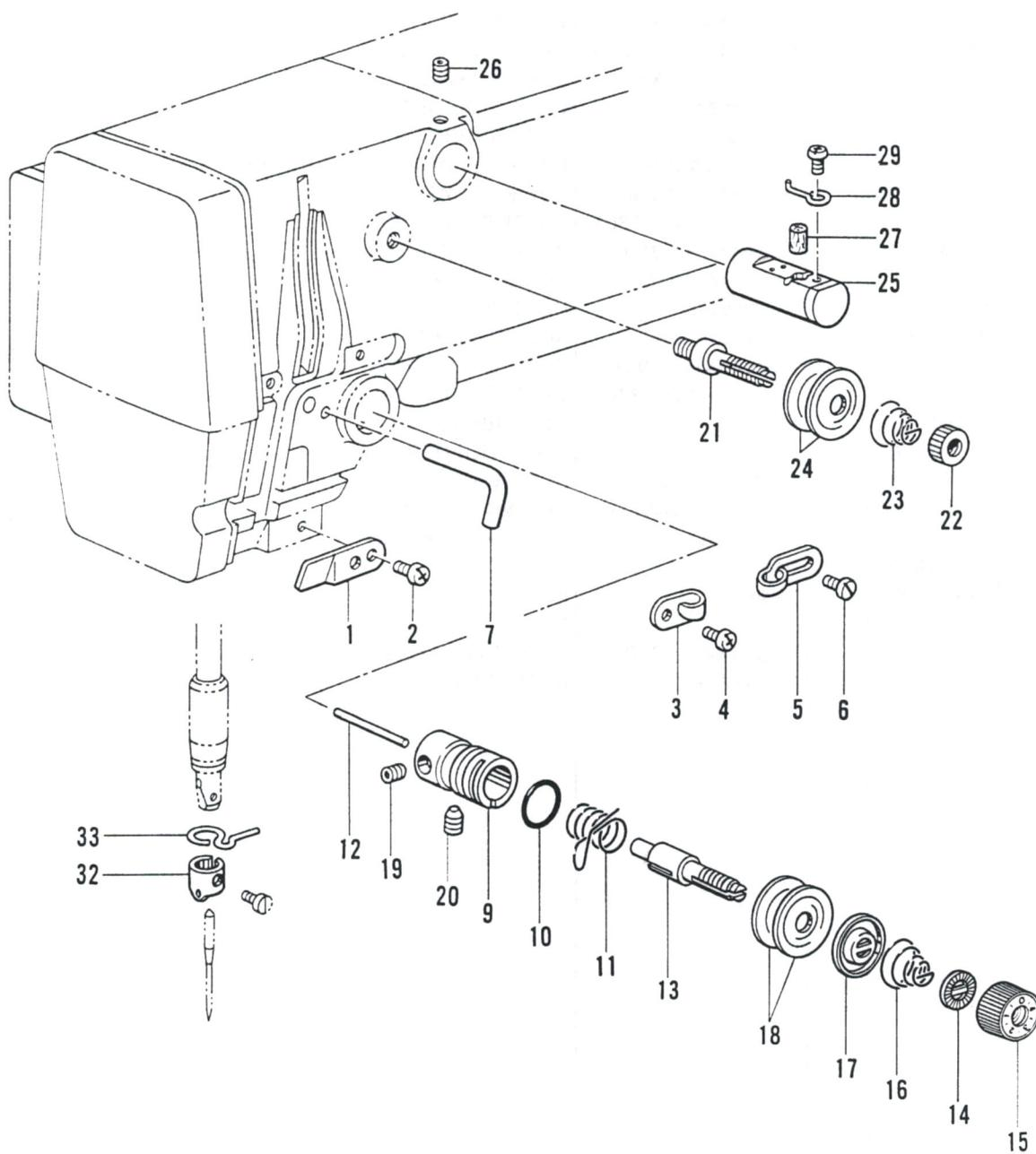
J. 糸通シ関係 / Threading mechanism / Fadenführungs vorrichtung /
