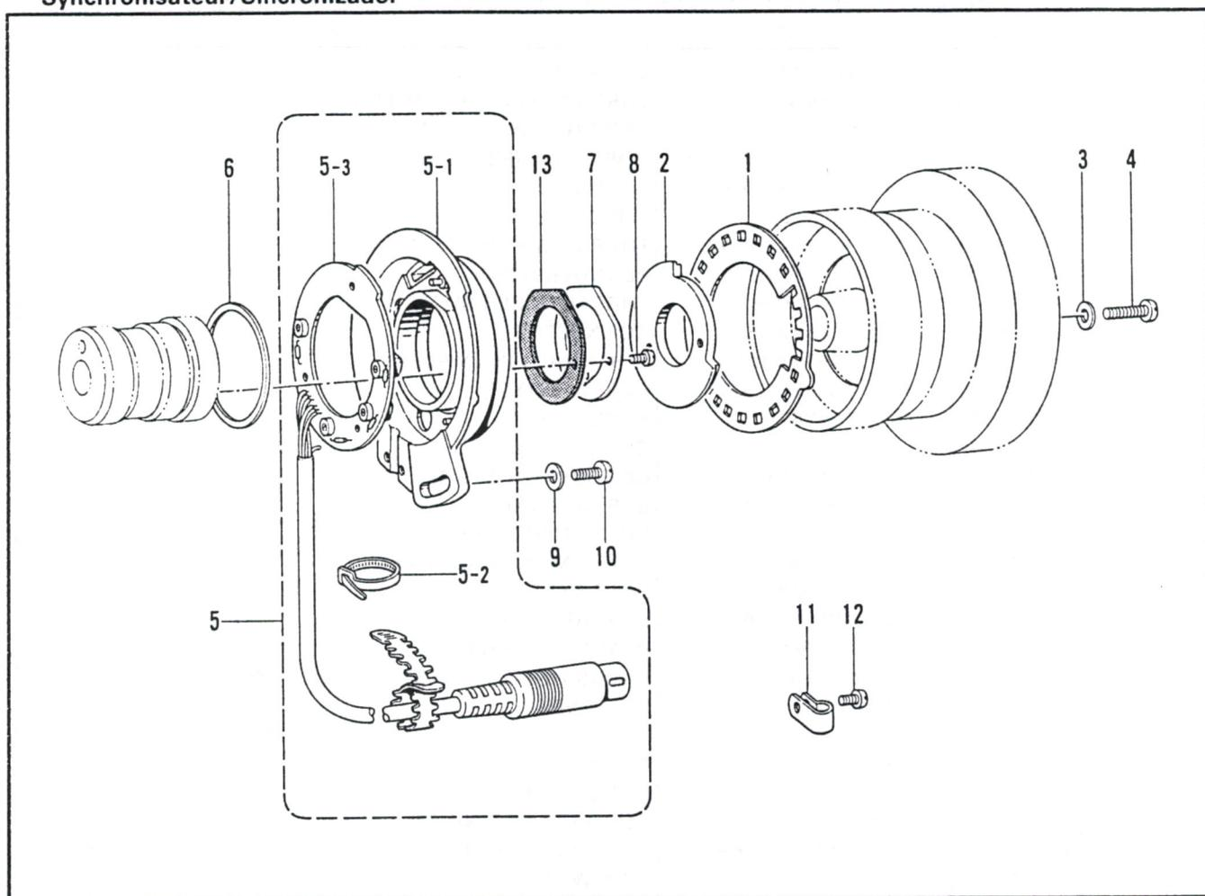
S. 踏板関係/Foot switch pedal mechanism/Fußbetätigungs/
