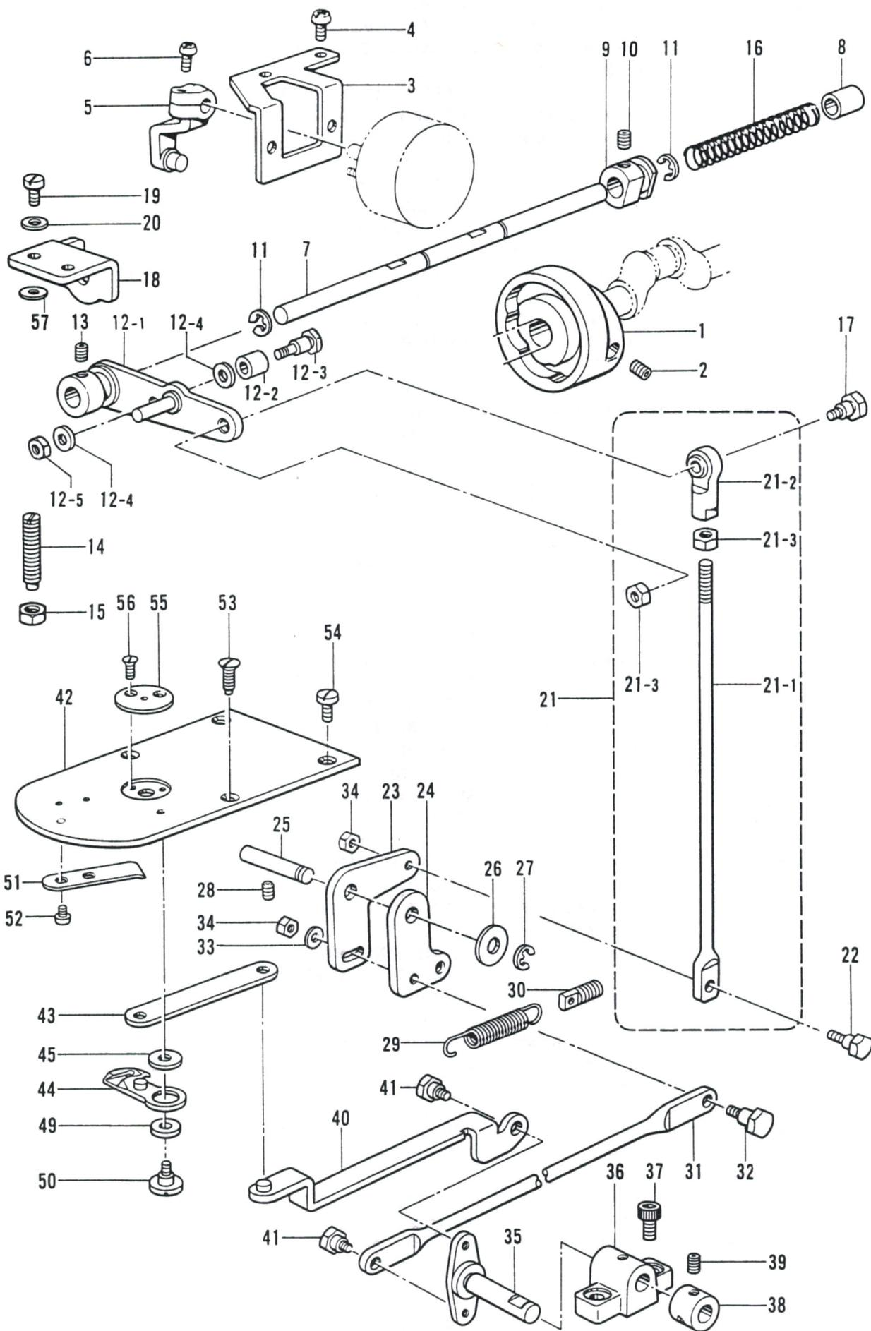
L. 糸切り関係/Thread trimmer mechanism/Fadenabschneidevorrichtung/
