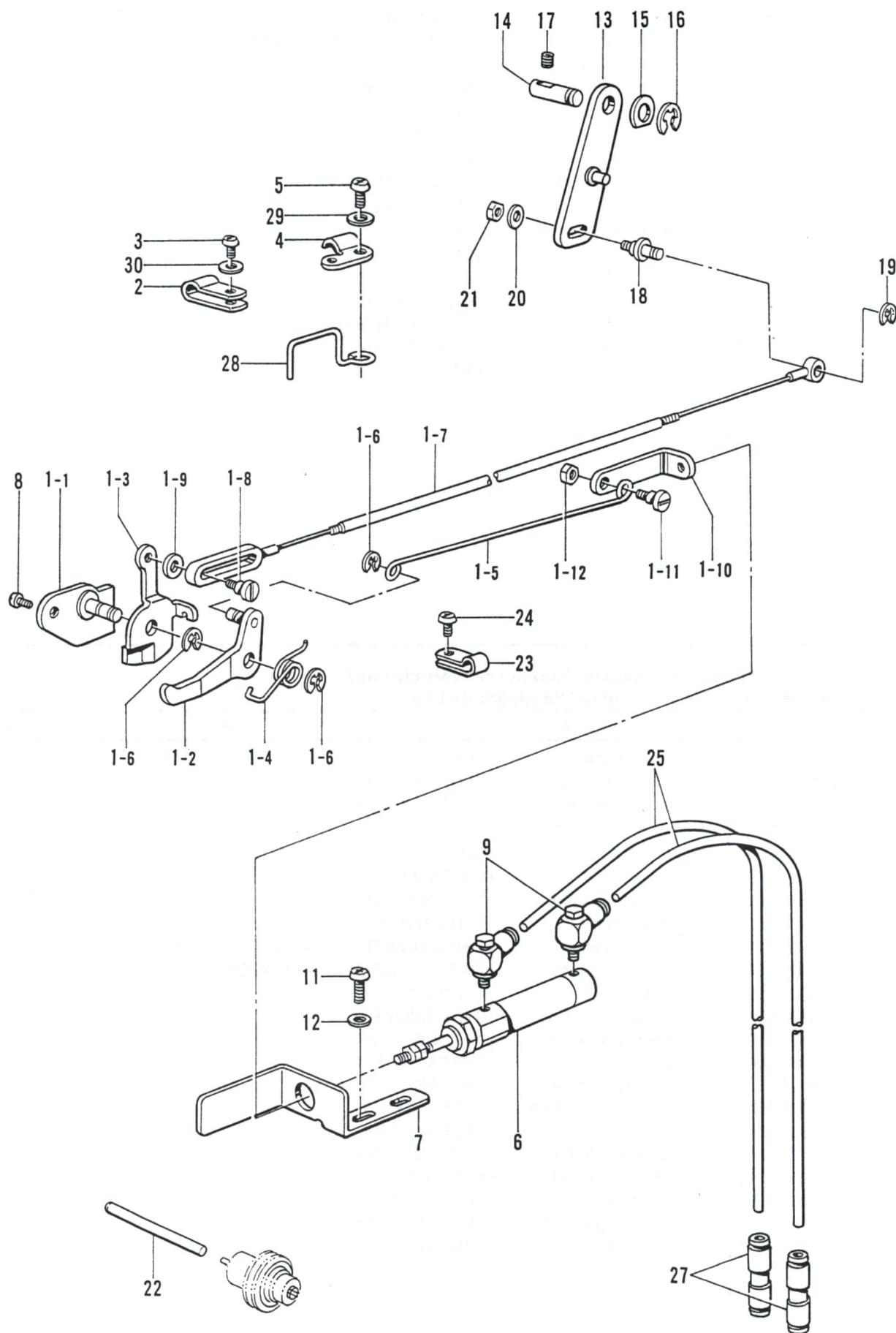
P. 糸締メ関係 / Thread nipper mechanism / Fadenspannvorrichtung /
