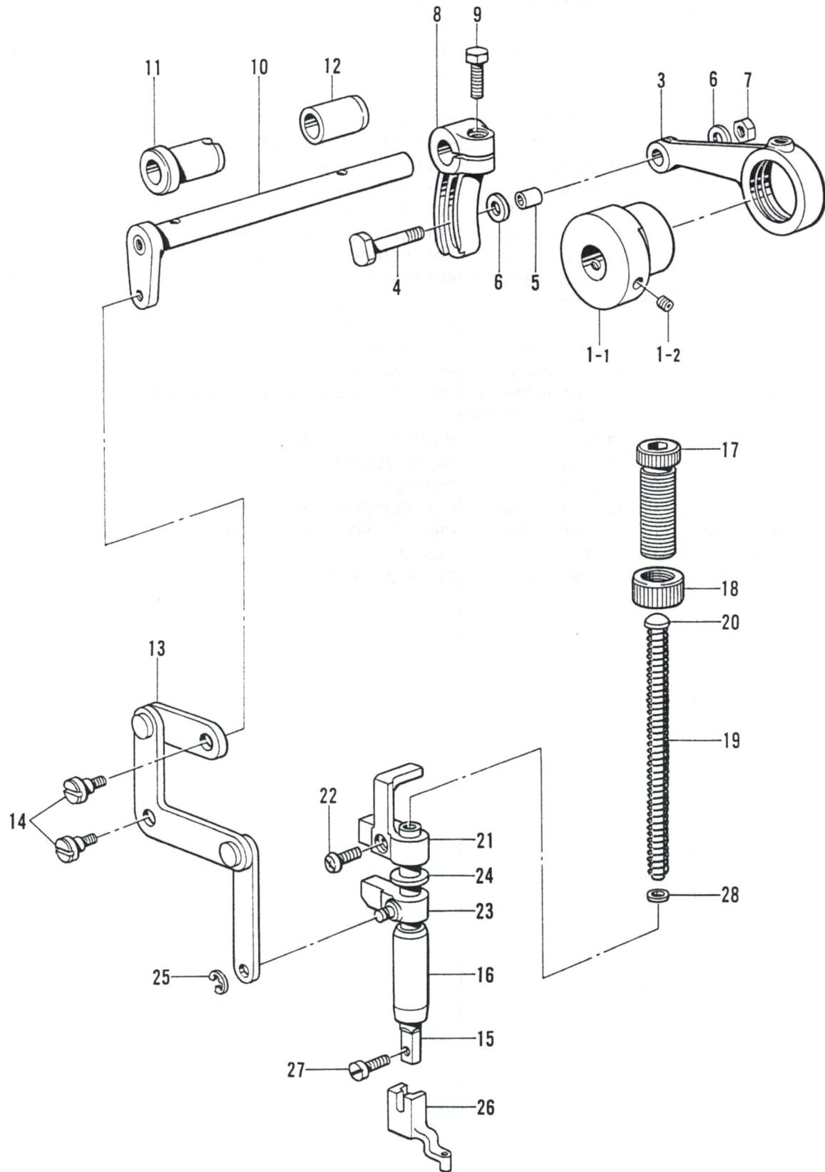
E. 押工上ヶ関係 / Work clamp lifter mechanism / Stoffhalterhebervorrichtung /
