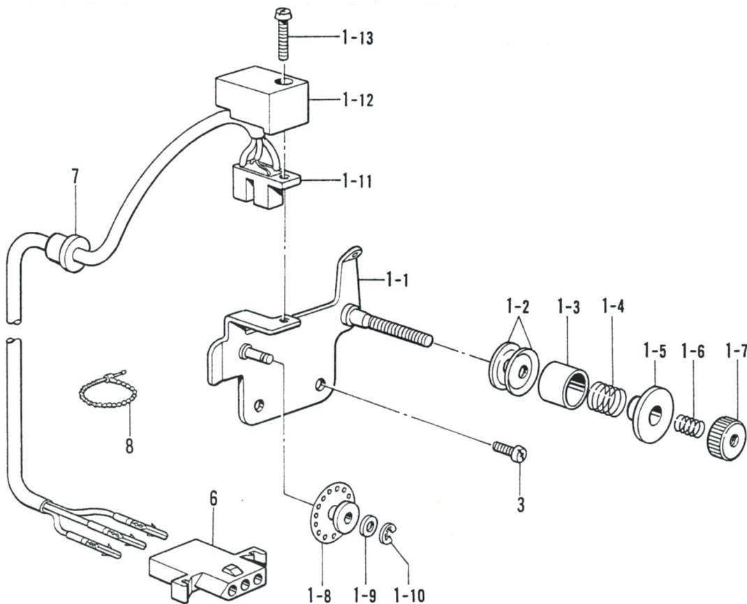
N. 糸拭き関係 / Thread wiper mechanism / Fadenwischvorrichtung /
