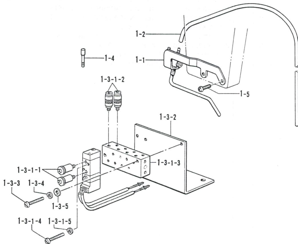
Y. 針冷却装置 /Needle cooler/Nadelkühlungsvorrichtung/
